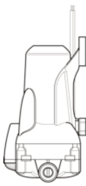
Fig 2 - Orientation recommandée du montage de la pompe
