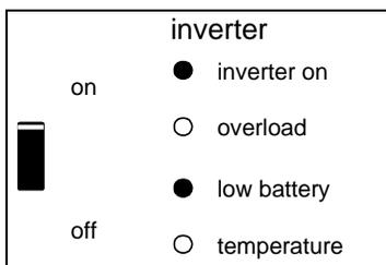
L'inverter si è spento a causa della bassa tensione della batteria.
