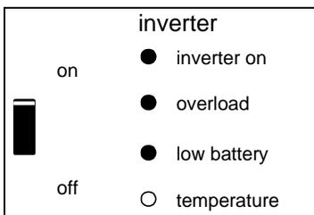
De omvormer is uitgeschakeld vanwege een te hoge rimpelspanning op de accuaansluiting.
