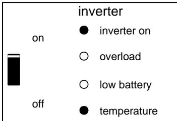
Le convertisseur s'est arrêté à cause de la température trop élevée de l'électronique.
