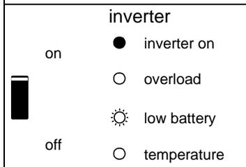
La batteria è quasi completamente scarica.
