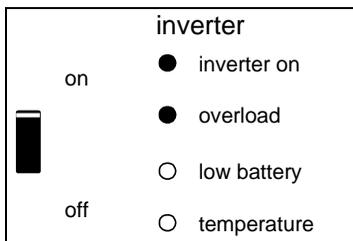
L'inverter si spegne a causa di sovraccarico o cortocircuito.
