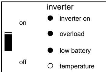
Le convertisseur s'est arrêté à cause d'une tension d'ondulation trop élevée aux bornes de la batterie.
