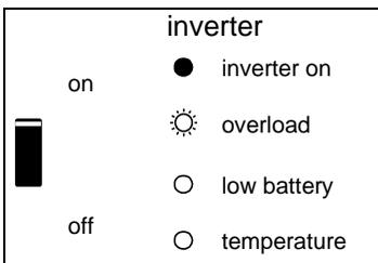
Se ha excedido la salida nominal del inversor. El LED indicador de “sobrecarga” parpadea.
