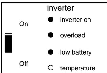
Växelriktaren har stängts av på grund av för hög brumspänning på batteripolerna.
