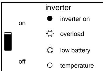
– A lampeggio alternato dei LED corrispondono gli stati di batteria quasi scarica e superamento dell'uscita nominale.
