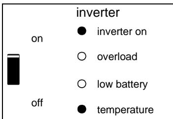
L'inverter si è spento per temperatura troppo elevata dell'elettronica.
