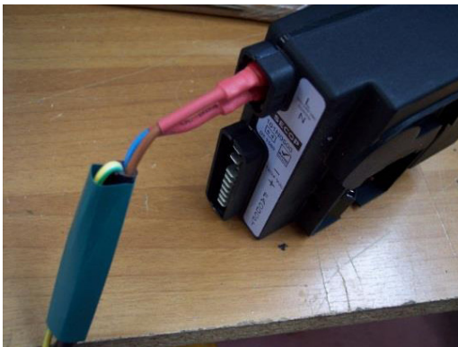
Afbeelding 11: Detail aansluiting met dubbele isolatie
