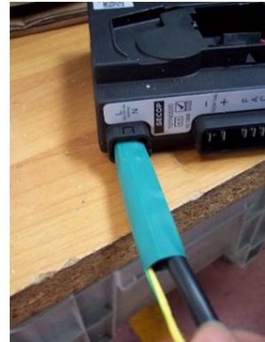
Abbildung 11: Detailansicht doppelt isolierter Anschluss
