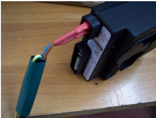
Abbildung 11: Detailansicht doppelt isolierter Anschluss
