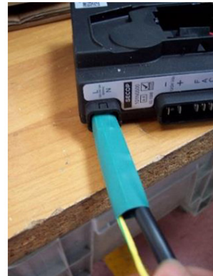
Figure 11 : Connexion particulière à double isolation
