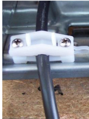
Abbildung 13: Detailsicht doppelte Kabelbefestigung
