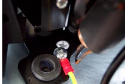
Afbeelding 12: Detail aansluiting aardkabel aan het metalen deel van de compressor
