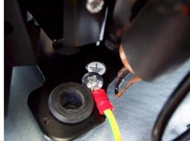
Kuva 12: Maadoitusjohto kompressorin metalliosassa
