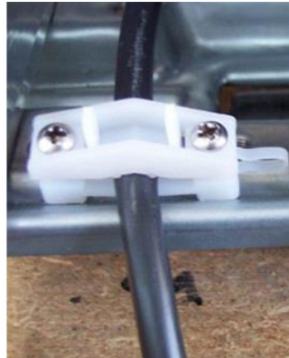
Figure 13 : Détail fixation double du câble
