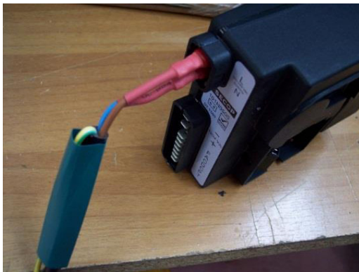
Figura 11: Particolare connessione doppio isolamento
