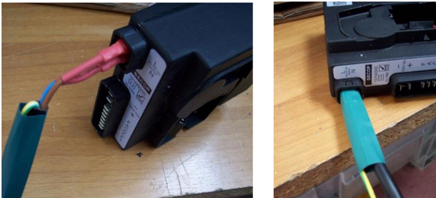
Рисунок 11: Деталь соединения с двойной изоляцией
