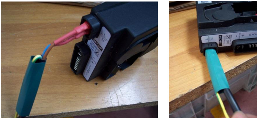
Figura 11: Detalle de conexión con doble aislamiento
