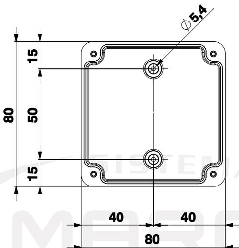
Per il montaggio del pannello di controllo all'interno di una plancia strumenti, forare la plancia seguendo la dima di foratura sottostante:
