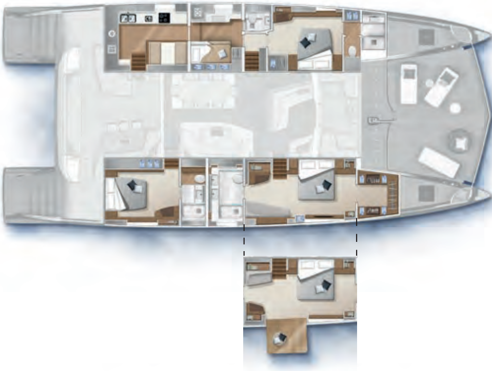
Version cuisine et quartier équipage à l'arrière bâbord Galley and crew cabin version on the aft port side
