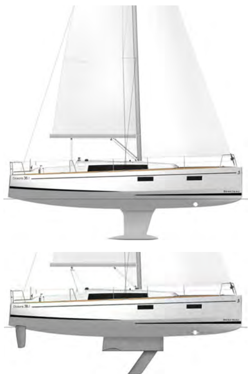
Lifting keel option cradle
