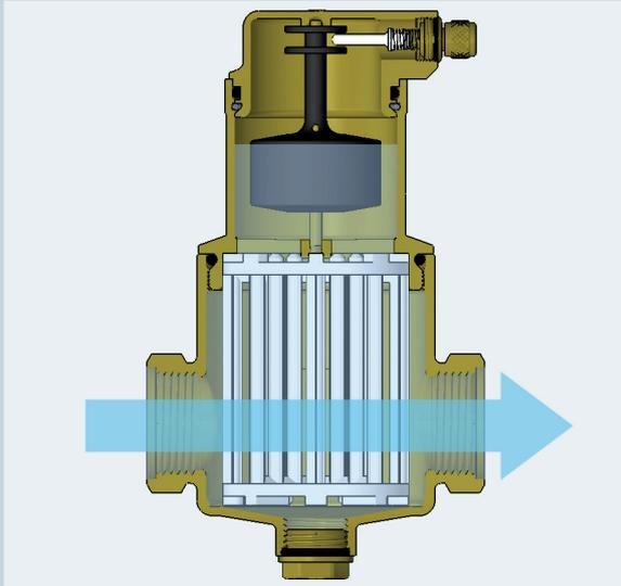
**PHASE OF OPERATION IN THE PRESENCE OF AIR BUBBLES**
