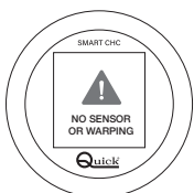
AVVISO SENSORE NON RILEVATO O ATTIVAZIONE TONNEGGIO
